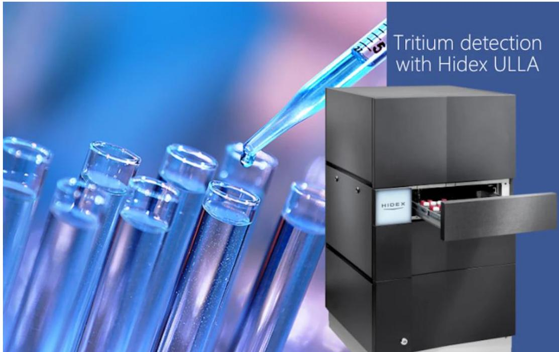
研究得出結論，Hidex ULLA 計數器是一種準確可靠的儀器，可用於檢測現代環境水樣本中的氚含量。研究報告稱，與 Quantulus 1220 進行比較是可行的。Quantulus 1220 儀器的 FoM 和 DL 典型值（在同一設施中使用類似的最佳化計數程序）分別為 1245 和 5.77 TU，背景訊號為 0.58 CPM — 結果與 ULLA 系統報告的結果一致
